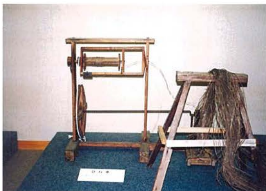
④ひね車 おもて たたみ表を織るときに使う糸を作る道具。 (益田市立歴史民俗資料館蔵)
